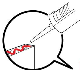
**Dépoussiérez et dégraissez le haut du meuble, la vasque et le mur avant la pose du joint.** Appliquez le silicone en joint continu, avec un pistolet, en évitant toute inclusion d'air.
