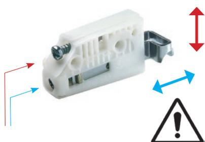
Utilisez les deux vis de réglage afin de mettre l'armoirette de niveau, puis verrouiller la contre le mur. **Il est important que les côtés soient parfaitement d'aplomb et que le dessus soit de niveau** (aidez-vous d'un niveau à bulle).
